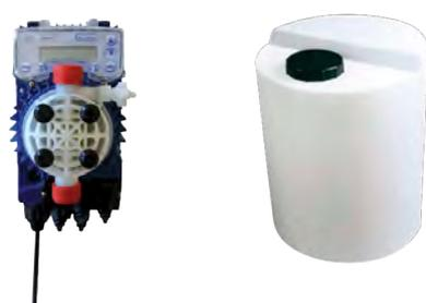
Sistema di dosaggio soluzione disinfettante a mezzo pompa dosatrice elettronica. La disinfezione avviene tramite avvio del sistema di dosaggio durante la fase di aspirazione della salamoia. La pompa dosatrice deve essere collegata elettricamente alla valvola di comando dell'addolcitore.
